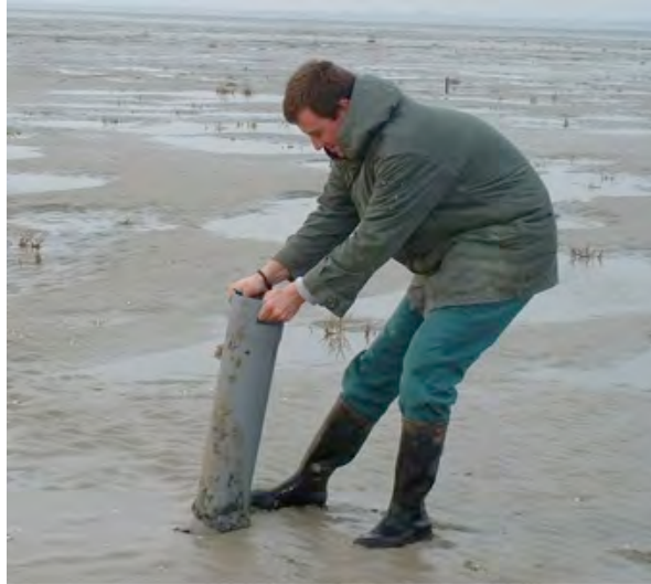
Figure 3 : carottier composé d'un tube de PCV épais et muni d'une poignée (cl. P. Triplet)
