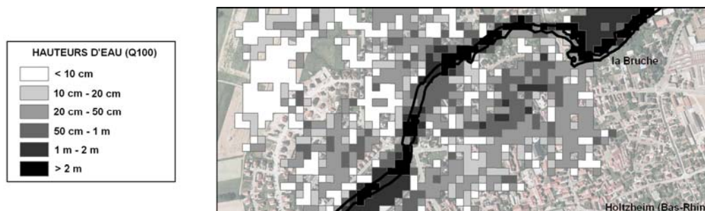
Figure 1 : Enveloppe de crue de période de retour égal à 100 ans, utilisée dans l'évaluation des dommages dans la basse Bruche, Bas-Rhin, France.
