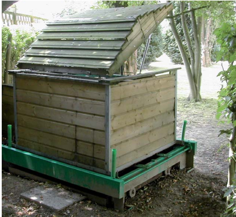
Le contenant surmonte un dispositif d'extraction par balayage à la surface d'une grille.
